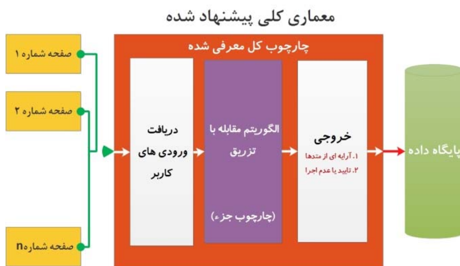
شکل ۲- معماری کلی به عنوان میانجی و دیوار آتش
